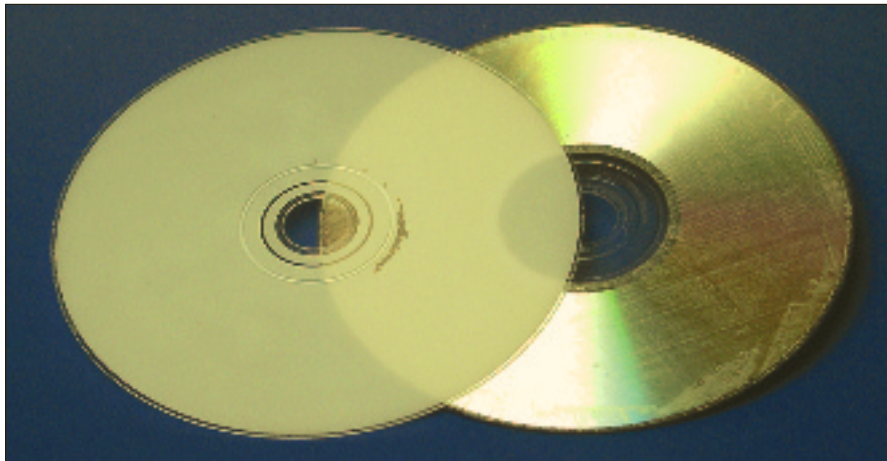
Figura 1: DVDs compuestos de dos discos pegados conjuntamente de 0.6 milímetros de espesor. La capa de reflexión, que se daña muy fácilmente, está protegida en el centro entre los dos discos.
