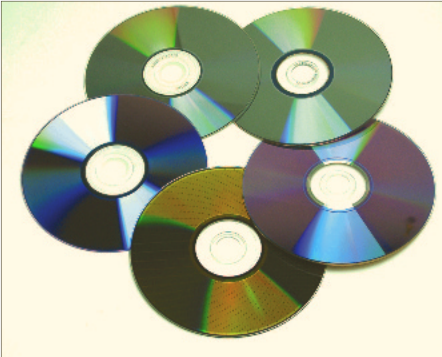
Figura 2: vista de los 5 discos grabables de DVD: DVD-RW arriba a la izquierda, DVD+RW arriba a la derecha, DVD-R abajo a la izquierda, DVD+R abajo a la derecha y DVD-RAM abajo. Las diferencias en las características de reflexión son fácilmente reconocibles.
