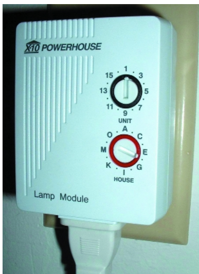
Figura 4: La dispositivo X10 espera a la señal y conecta y desconecta la lámpara.
