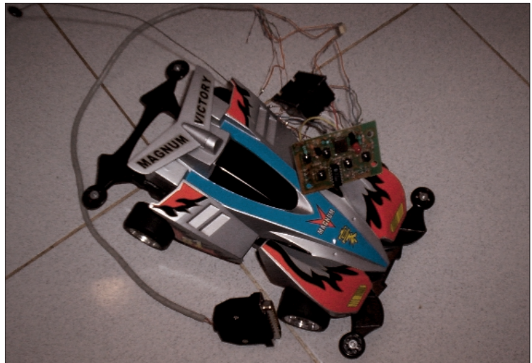
Figura 3: Nuestro cochecito, comprado en una tienda de todo a 60 céntimos, con la placa creada y el cable para el puerto paralelo.
