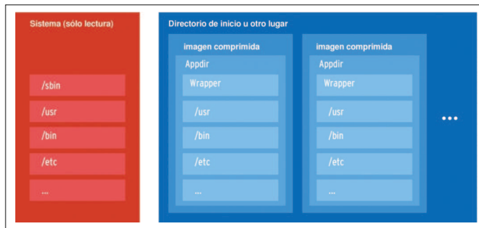
Figura 2: Cada paquete comprime su propio sistema de ficheros Linux con un script wrapper en la parte superior. El directorio con los ficheros está referido al AppDir. El directorio AppDir está comprimido para Klik. Tal y como muestra la figura, pueden coexistir múltiples paquetes.
