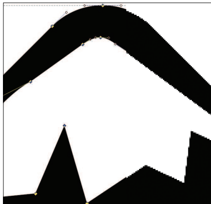
Figura 4: En esta imagen hemos aumentado drásticamente el tamaño de 1 gráfico, en la parte izquierda en su versión vectorial y en la derecha en la de mapa de bits.
