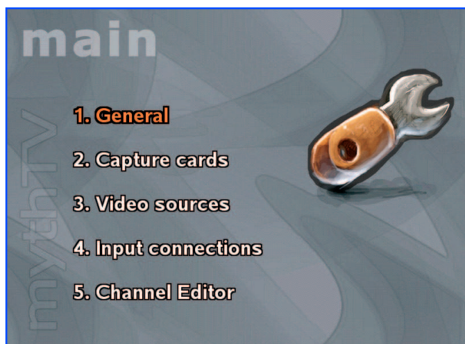
Figura 2: Menú principal del programa setup. Se despliega los elementos del menú de arriba a abajo. Las teclas Tab y de flechas permiten navegar entre los campos y Esc nos vuelve al menú principal. Si pulsamos la barra espaciadora se seleccionan las opciones destacadas.
