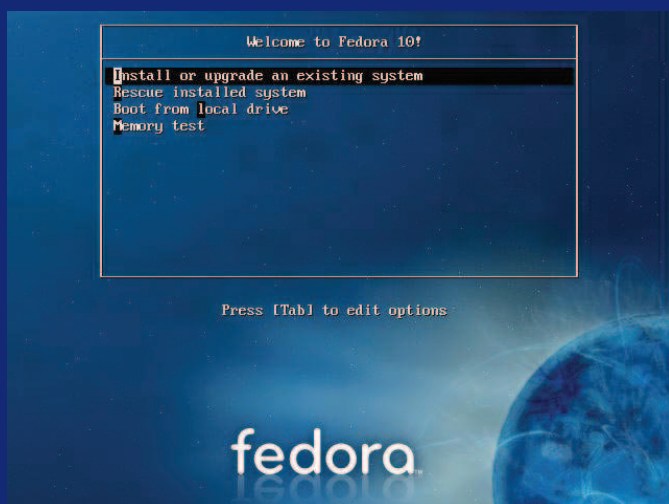
Figura 1: Pantalla de inicio de la instalación. Para más opciones se pulsa F1, F2 ó F3.
