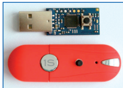
Figura 3: Si no nos atrevemos a soldar, podemos adquirir un OpenKubus prefabricado. Esta versión incluye el driver para USB en su microcontrolador ATmega16U4.
